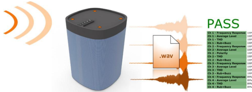
图 11: 使用 KLIPPEL QC 系统基于 wav 文件测试的智能音箱 4 个麦克风响应
